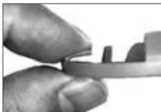
Fig.4 Clip piegate all'interno con movimento "a pizzicotto".
