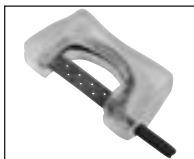
Figure 3 : lime correctement insérée dans le dispositif de préhension.
