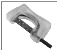
Figura 3: Lima insertada completamente en el sujetador
