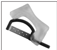
Figur 1: Filens skaft er korrekt monteret i hullet på grebet
